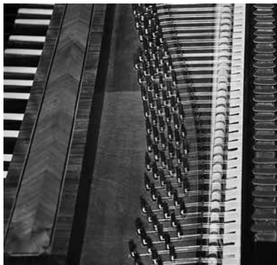
Pianoforte, détail de la mécanique viennoise
